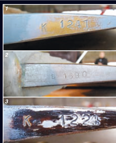
Как установить контрафактность лопасти рулевого винта вертолетов типа Ми-8 (по цвету покрытия на торце кронштейна лопасти):
